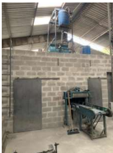
Figura 7 – Após a prensa do bloco, é transportado pela esteira para ser armazenado para seu tempo de cura inicial que seria de 24 horas (fonte: Acervo pessoal, 2020).
