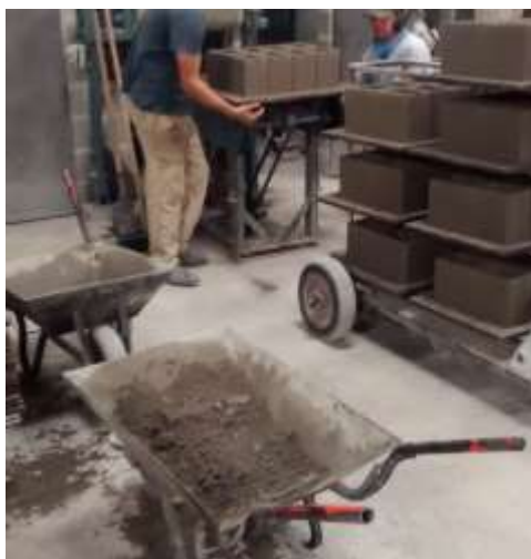
Figura 19 e 20 – Mostrando blocos já desformados e na estufa para secagem inicial e posterior para ser armazenado corretamente (fonte: Acervo pessoal, 2020).
