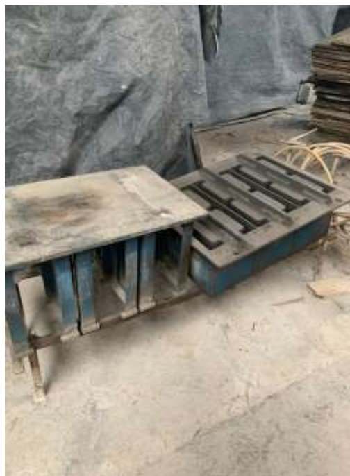
Figura 5 e 6 – Prensa e o molde utilizado conforme a família do bloco (fonte: Acervo pessoal 2020).
