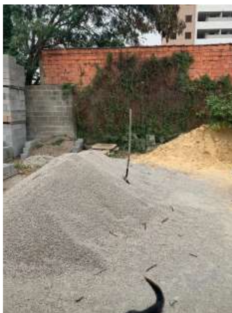
Figura 1 – Agregado de areia na cor clara e o agregado de pedra na cor cinza escuro (fonte: Acervo pessoal, 2020).
