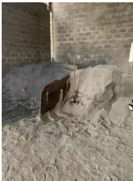
Figura 2 – Agregado de pó granito na cor cinza claro e o agregado de pó calcário na cor cinza escuro (fonte: Acervo pessoal, 2020).
