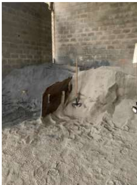
Figura 15 – Agregado de pó granito na cor cinza claro e o agregado de pó calcário na cor cinza escuro (fonte: Acervo pessoal, 2020).
