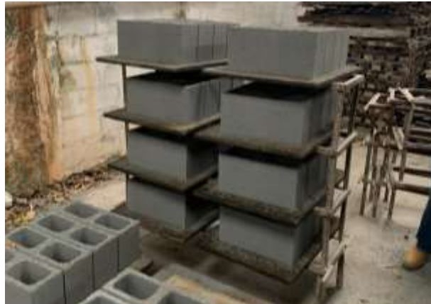
Figura 17 e 18 – Mostrando a forma de confecção dos blocos estrutural e de vedação assim como eles desformados (fonte: Acervo pessoal, 2020).
