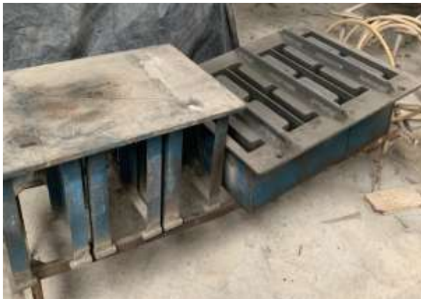
Figura 17 e 18 – Mostrando a forma de confecção dos blocos estrutural e de vedação assim como eles desformados (fonte: Acervo pessoal, 2020).
